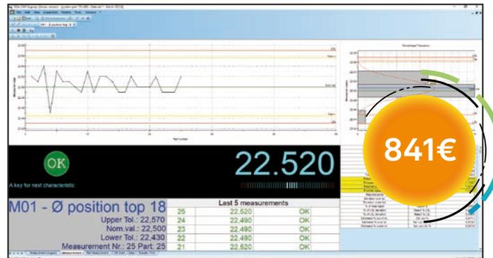
Mit dem TESA DATA-VIEWER können alle Messergebnisse einfach und schnell in ein Datenverarbeitungsprogramm exportiert werden oder Dateien in den bekannten Formaten wie \*.xls, \*.csv oder \*.txt automatisch erstellt werden. TESA DATA-VIEWER kann kostenlos von der TESA-Website heruntergeladen werden<sup>1</sup>. <https://go.hexagonmi.com/DATA-VIEWERsoftware>
