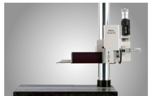
Optionale Autoset-Einheit, X-Achsen-Einstelleinheit und digitale Nivelliereinheit, adaptiert am Granitständer.
